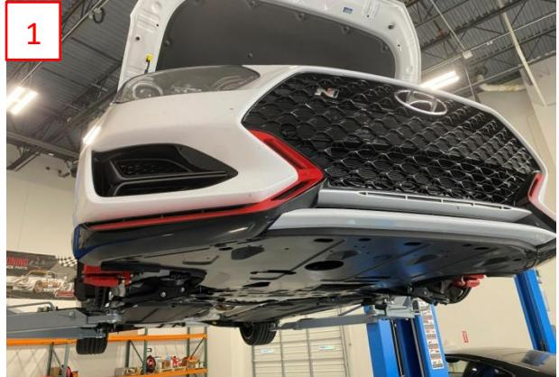
Demontieren Sie die untere Luftführung des Ladeluftkühlers (2).
