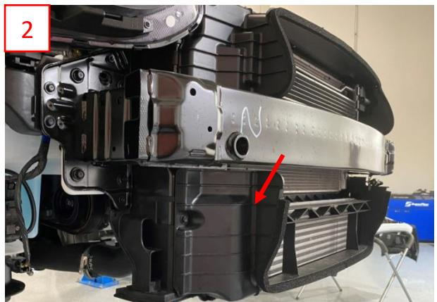
Demontieren Sie die originalen Silikonschlüsse am Ladeluftkühler (3).
